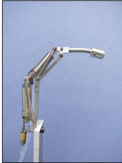
Figura 18. Detalle del dedo actuado por pistones hidráulicos
