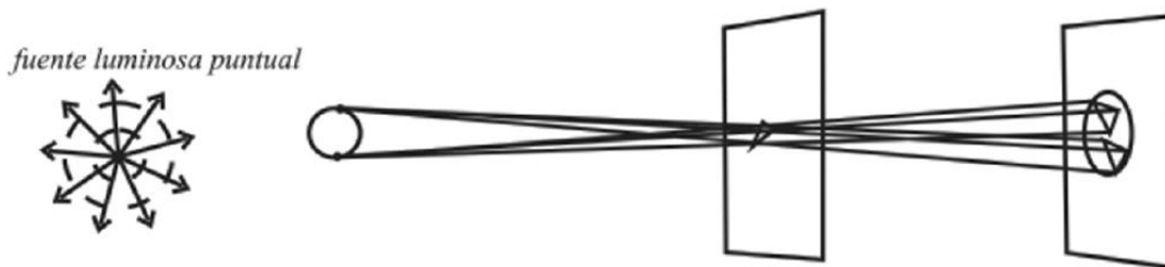
Imagen 6. Representación de Kepler sobre cómo se ven las imágenes a través de una cámara oscura. Fuente: (Osuna, Martínez, Carrascosa, & Verdúl, 2007).
