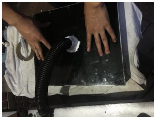
Figura 74. Parte de abajo de la caja de vacío conectada a la manguera de succión.
