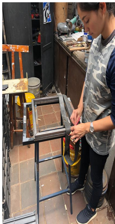
Figura 111,112. Pegado de cauchos protectores, ensamble de bisagras.
