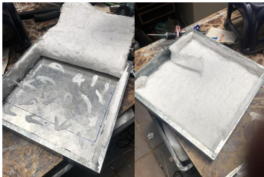
Figura 48,49. Pegado de la fibra de vidrio.
