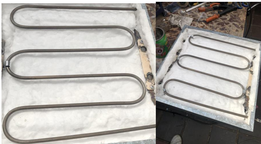
Figura 52,53. Resistencia fijada a la caja.
