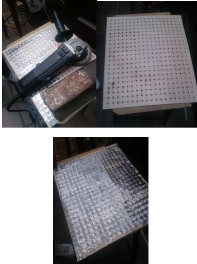
Figura 85,86,87. Lámina perforada terminada.
