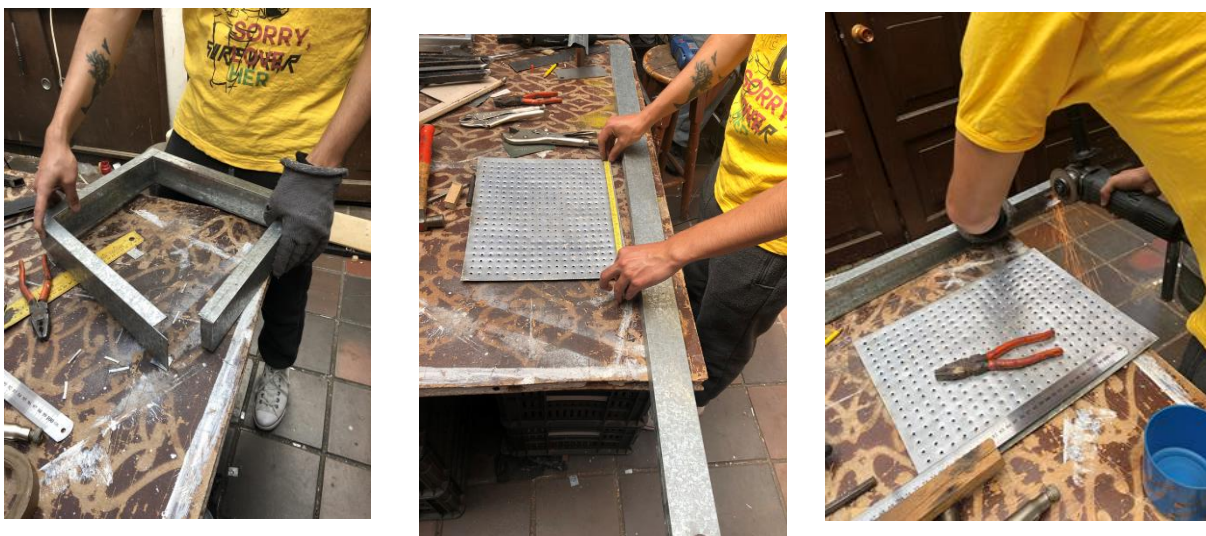
Nota: Medición de la caja de vacío, corte de la caja de vacío, ensamble de la caja de vacío. Fuente: Autores.
