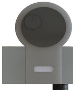
Figura 40. Control de temperatura de la resistencia.
