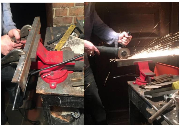
Figura 54,55. Proceso de corte de la lámina de acero.
