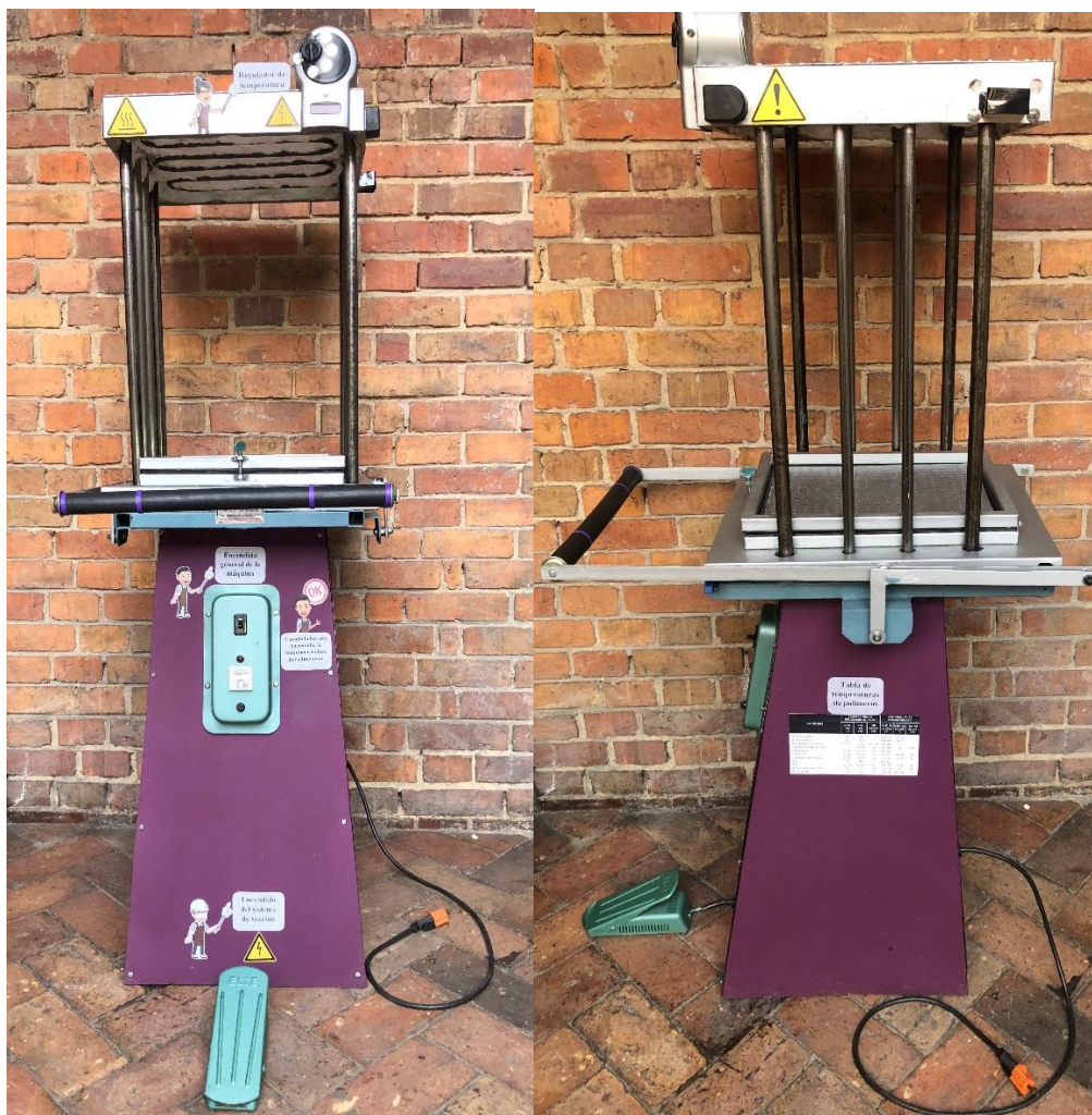
Figura 120,121. Prototipo de máquina termoformadora ensamblado y terminado.
