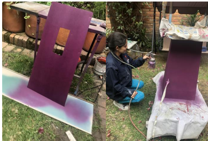
Figura 118,119. Pintado de tapas metálicas.
