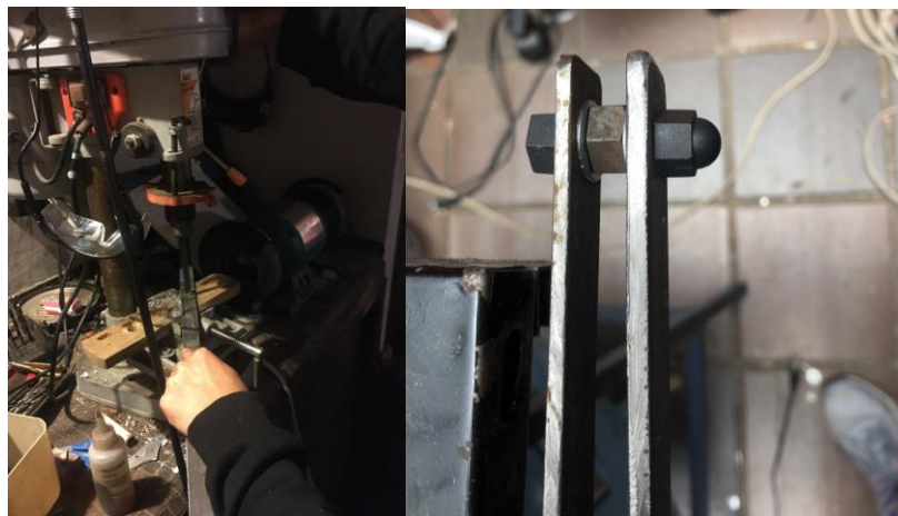
Nota: Perforación con taladro de árbol, tornillos de la palanca. Fuente: Autores.
