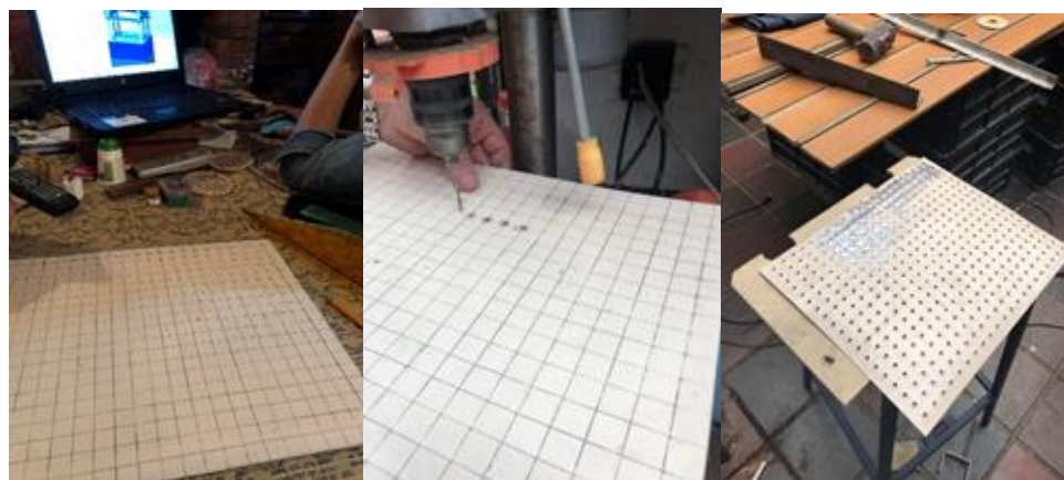
Figura 79,80,81. Trazos completos de perforación, perforación con taladro de árbol, lámina completamente perforada.
