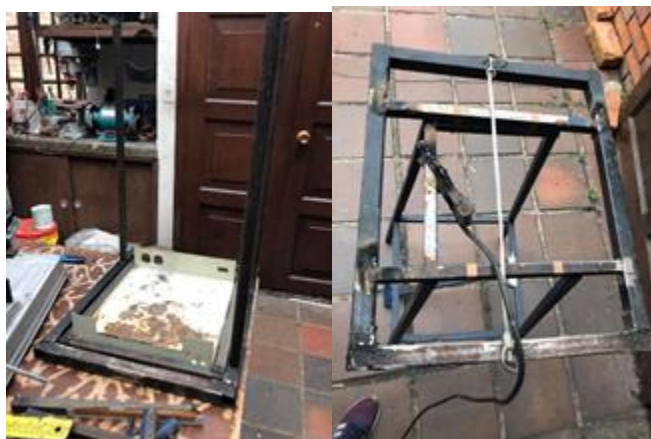
Nota: Piezas soldadas con arco eléctrico. Fuente: Autores.
