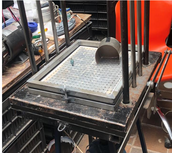
Figura 113. Marco de sujeción ensamblado en la estructura.
