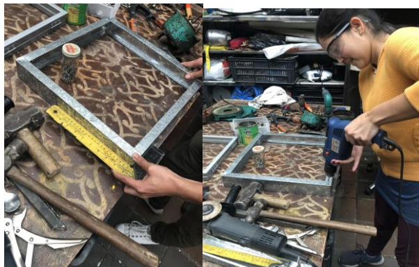
Nota: Fabricación caja de la resistencia. Fuente: Autores.
